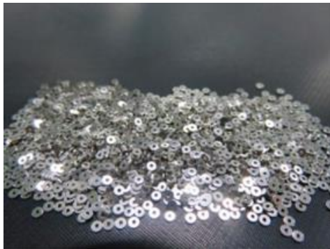
Links: Platin-Iridium-Legierung, röntgendichtes Markierungsmittel
