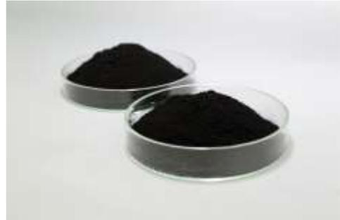
Elektrokatalysator für Polymermembran-Brennstoffzellen
