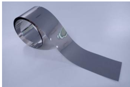
マンモグラフィ用フィルター向けロジウム（Rh）シート
