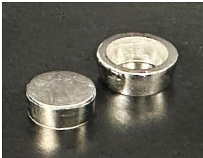
<使用此技術製造的白金材料（圓柱狀和環狀）>
