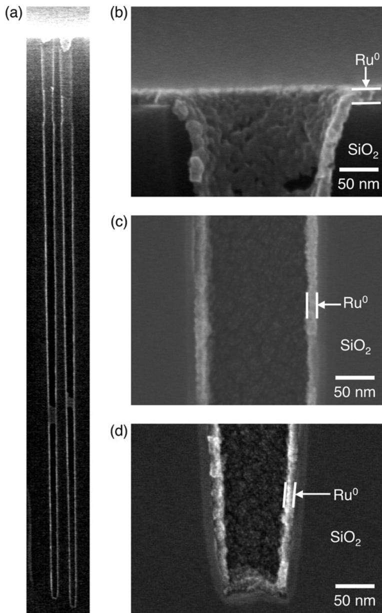
圖(a) 於深度 10 微米、開口直徑 250 奈米的細孔（長寬比為 40 比 1）內部所形成的釤薄膜之觀察影像（以掃描式電子顯微鏡 SEM 觀察之結果）
