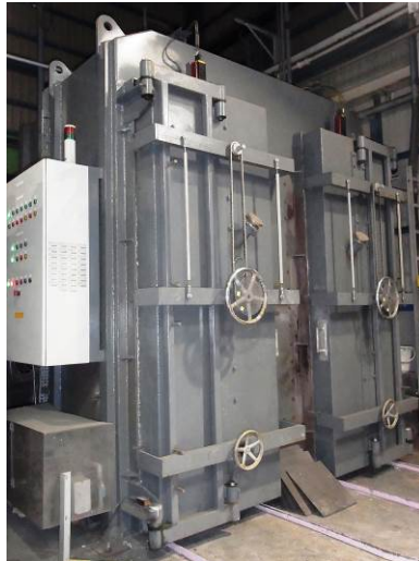
進行氰化合物分解處理的鍋爐外觀
