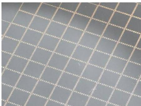
印刷於 8 吋矽晶圓基板上的「AuRoFUSE™」的密封外框外觀（200 μm 寬）
