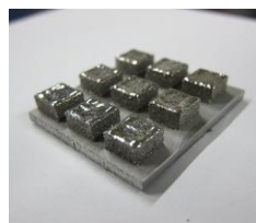
鉑基金屬玻璃造形物體 (1塊 8×8×5 mm)
