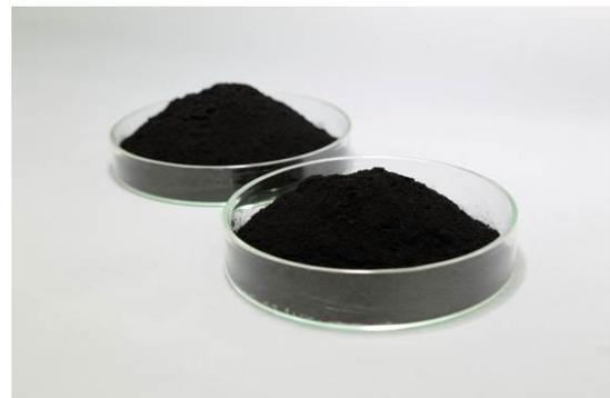
田中貴金屬工業製 燃料電池電極觸媒
